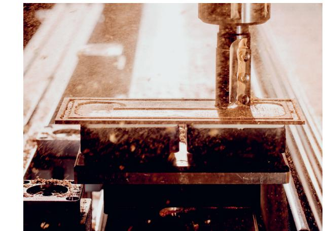
Las láminas se prensan y se cortan para alcanzar el formato final. Con el fin de obtener estabilidad adicional, se fresa el reverso de la placa de madera y se encolla a una placa de acero inoxidable. El logotipo de AXOR se graba con láser en la placa. Los aceites aplicados al final del proceso protegen el material y le confieren una estética noble.
