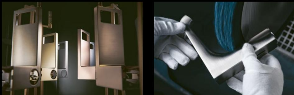
Los acabados PVD de AXOR FinishPlus se distinguen por su marcado carácter. Cada color es resultado de una intensa labor de desarrollo, y se obtiene en las cámaras de vacío de AXOR con el método PVD (Physical Vapour Deposition). En el interior de las cámaras, se descarga un arco eléctrico que provoca la reacción de los gases. El circonio resultante se deposita entonces en la superficie cromada de la grifería.
