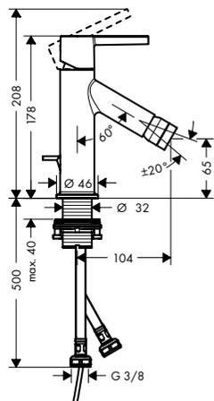
**Einhebel-Bidetmischer mit Hebelgriff und Zugstangen-Ablaufgarnitur**
