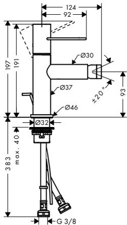
**Einhebel-Bidetmischer mit Zerogriff und Zugstangen-Ablaufgarnitur**
