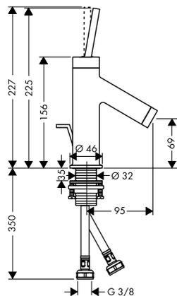
**Einhebel-Waschtismischer 70 mit Pingriff für Handwaschbecken mit Zugstangen-Ablaufgarnitur**
