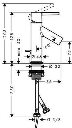
**Einhebel-Waschtischmischer 80 mit Hebelgriff für Handwaschbecken mit Zugstangen-Ablaufgarnitur**
