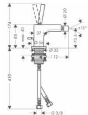
**Einhebel-Bidetmischer mit Zugstangen-Ablaufgarnitur**
