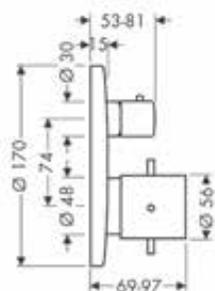
**Thermostat Unterputz mit Absperrventil**
