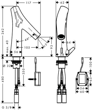
**Elektronik-Waschtischmischer mit Temperaturregulierung Batteriebetrieb**
