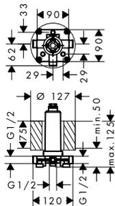
**Grundkörper für Kopfbrause mit Deckenanschluss**
