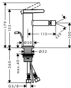
**Einhebel-Bidetmischer mit Zugstangen-Ablaufgarnitur**
