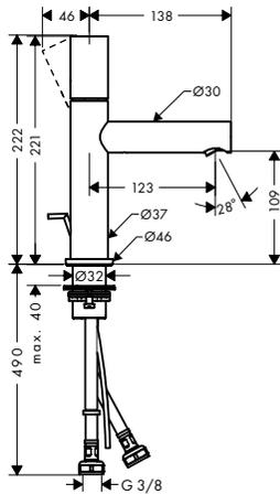
**Einhebel-Waschtismischer 110 mit Zero Griff und Zugstangen-Ablaufgarnitur**
