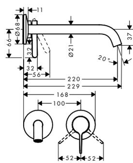
**Einhebel-Waschtischmischer Unterputz für Wandmontage mit Hebelgriff und Auslauf 220 mm**
