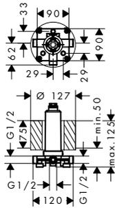
**Grundkörper für Kopfbrause mit Deckenanschluss**
