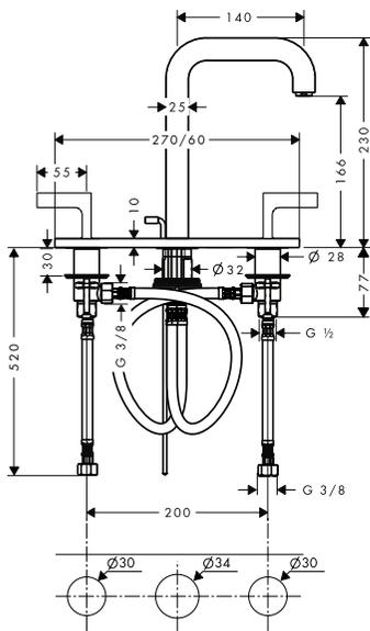
**3-Loch Waschtischarmatur 170 mit Auslauf 140 mm, Hebelgriffen, Platte und Zugstangen-Ablaufgarnitur**
