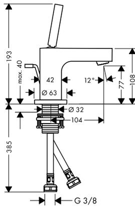
**Einhebel-Waschtismischer 80 mit Pingriff für Handwaschbecken mit Zugstangen-Ablaufgarnitur**
