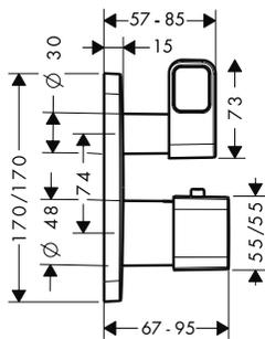
**Thermostat Unterputz mit Absperrventil**
