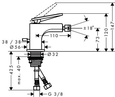
**Einhebel-Bidetmischer mit Hebelgriff und Zugstangen-Ablaufgarnitur**
