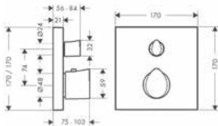
**Thermostat Unterputz mit Absperrventil**
