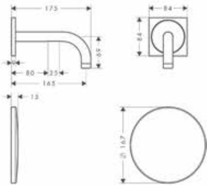
**Elektronik-Waschtismischer Unterputz für Wandmontage mit Auslauf 165 mm**
