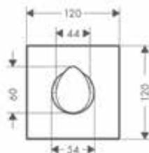
**Grundkörper für Absperrventil 120/120 Unterputz**
