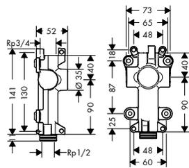
**Grundkörper/ Wasserführung für Ablage 120/120 Unterputz**
