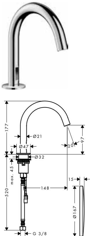
**Elektronik-Waschtischmischer mit Temperaturvoreinstellung Netzanschluss 230 V**
