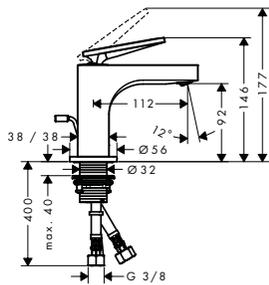
**Einhebel-Waschtismischer 90 mit Hebelgriff für Handwaschbecken mit Zugstangen-Ablaufgarnitur**
