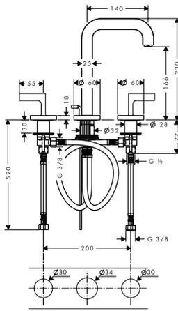
**3-Loch Waschtischarmatur 170 mit Auslauf 140 mm, Hebelgriffen, Rosetten und Zugstangen-Ablaufgarnitur**
