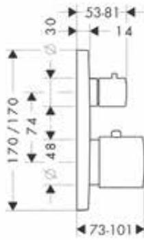
**Thermostat Unterputz mit Absperrventil**
