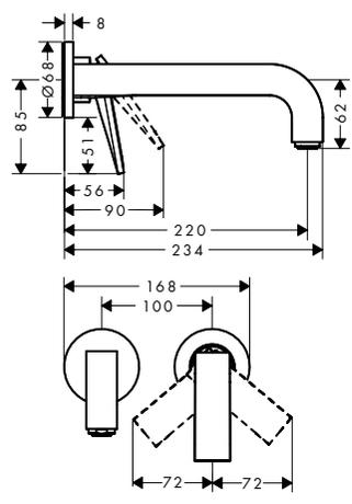
**Einhebel-Waschtischmischer Unterputz für Wandmontage mit Hebelgriff, Auslauf 220 mm und Rosetten**
