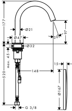
**Elektronik-Waschtischmischer mit Temperaturvoreinstellung Netzanschluss 230 V**
