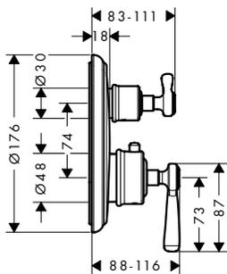
**Thermostat Unterputz mit Hebelgriff und Absperrventil**
