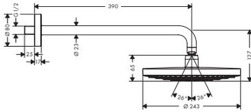
**飞雨 Select 240 2 速头顶花洒, 带花洒臂 390mm**
