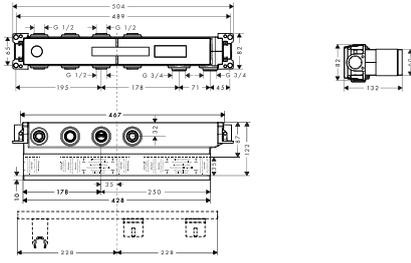
RainSelect 暗装 2 功能恒温模块基础套件
