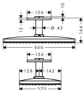
**幻雨魔法师 Select 460 单速花洒, 带天花板连接管 100mm**
