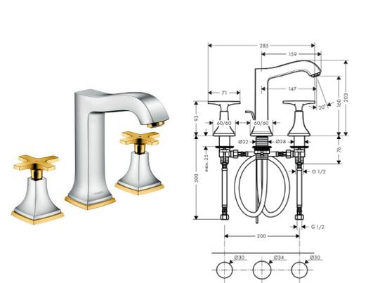
三孔面盆龙头 160 带十字把手带提拉落水套件
