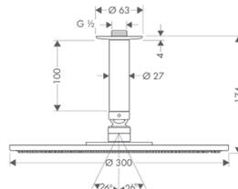
**飞雨 S 300 单速头顶花洒, 带天花板连接管 100 mm**
