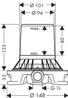
落地式缸边龙头暗装基础套件
