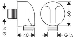
**Fixfit 花洒软管墙面连接件, 带单向阀及球形接头 DN15**
