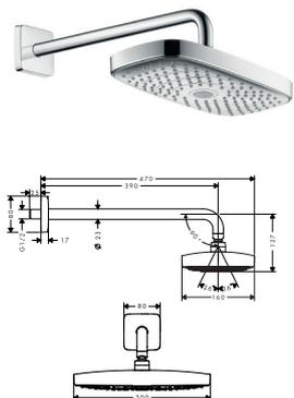
**飞雨 Select E300 2 速头顶花洒, 带花洒臂 390mm**
