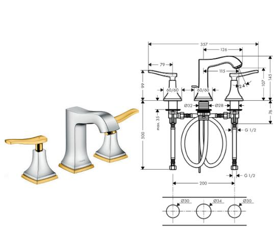
三孔面盆龙头 110 带一字把手带提拉落水套件
