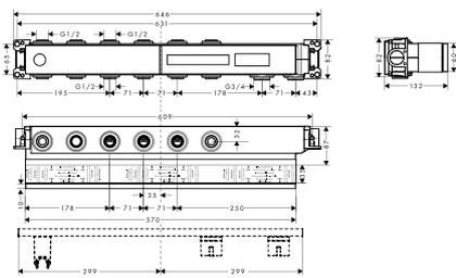
RainSelect 暗装 4 功能恒温模块基础套件
