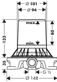
落地式缸边龙头暗装基础套件
