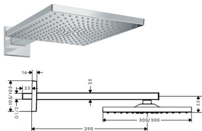
**飞雨 E 300 单速头顶花洒, 带花洒臂 390mm**
