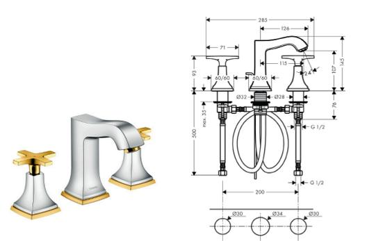
三孔面盆龙头 110 带十字把手带提拉落水套件
