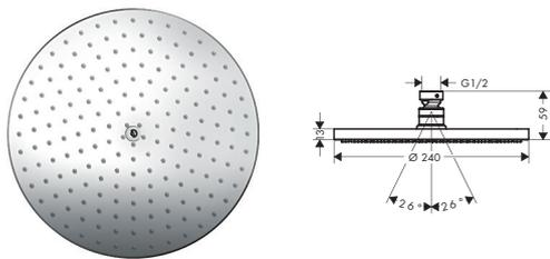
**飞雨 S 240 单速头顶花洒 PowderRain**
