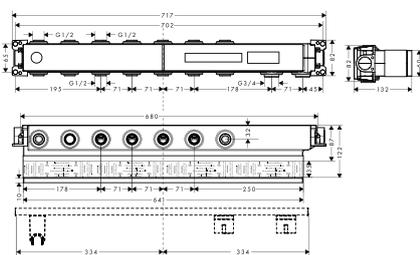
RainSelect 暗装 5 功能恒温模块基础套件
