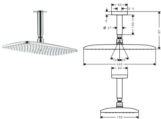
**飞雨 E 360 单速头顶花洒, 带天花板连接管 100mm**
