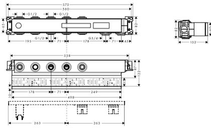
RainSelect 暗装 3 功能恒温模块基础套件
