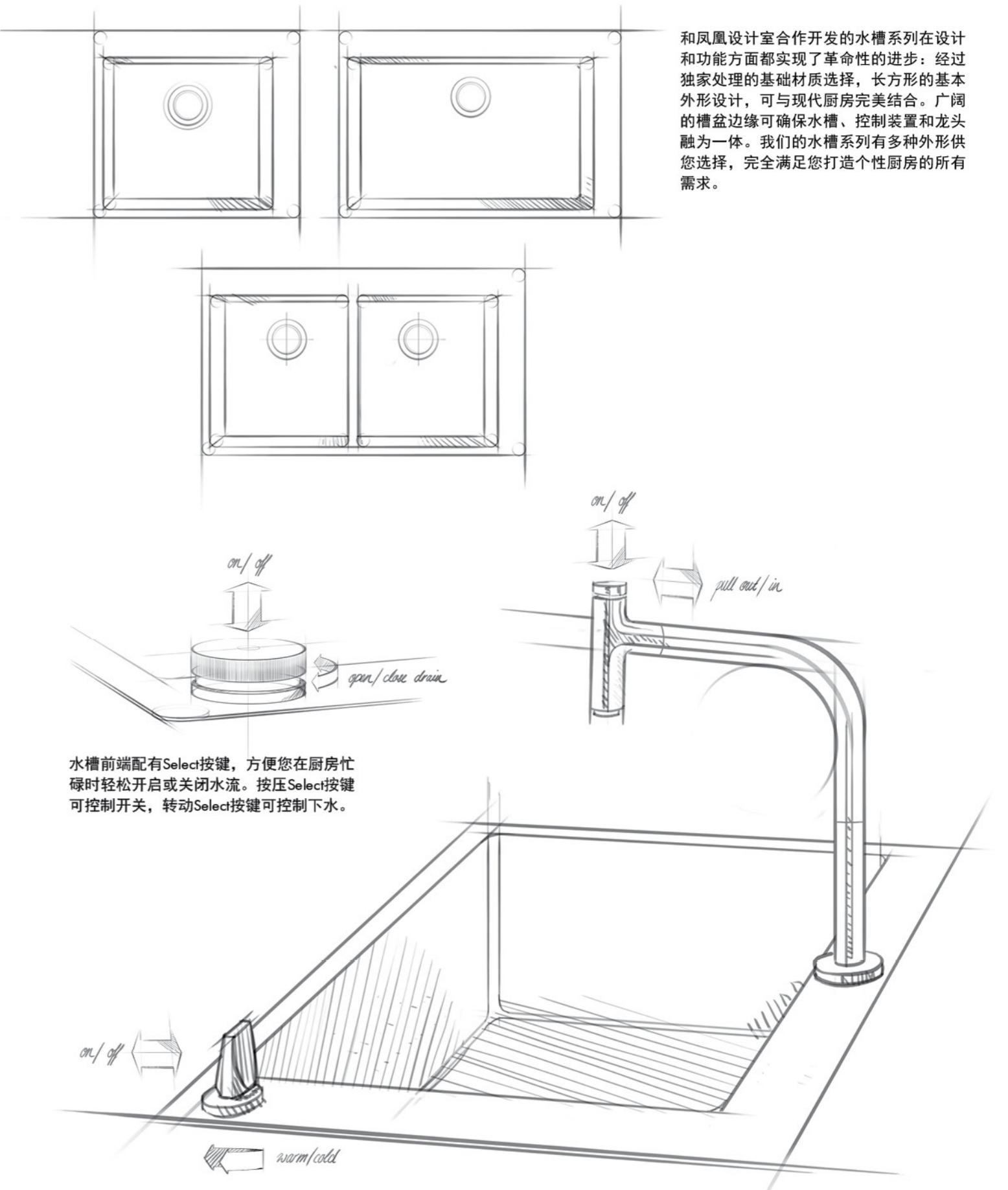
水槽前端配Select按键，方便您在厨房忙碌时轻松开启或关闭水流。按压Select按键可控制开关，转动Select按键可控制下水。
