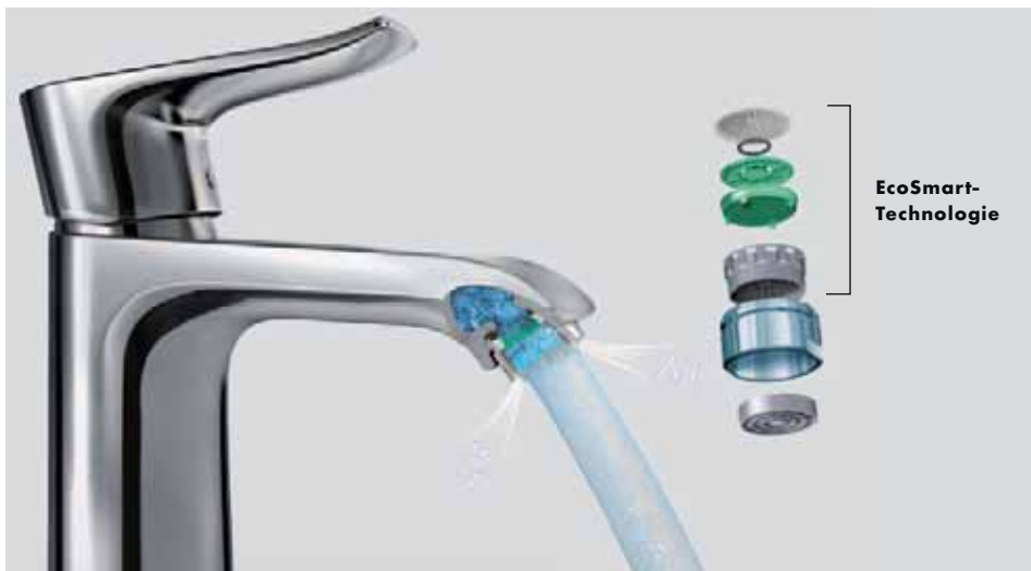
De precisie-O-ring reageert flexibel: is de waterdruk hoog, dan verkleint de doorstroomopening. Is deze laag, dan vergroot de opening.
