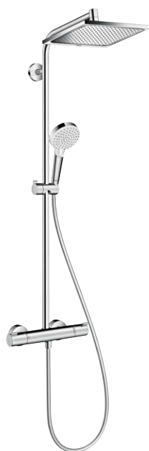
Crometta® E 240 Showerpipe com chuveiro fixo Crometta E 240, chuveiro de mão Crometta Vario e misturadora termostática Ecostat 1001 CL, braço de chuveiro de 350 mm # 27271, -000 # 27281, -000 (9 l/min) EcoSmart
