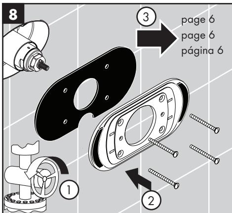
**Set the high temperature limit stop, justify the handle / Réglez la butée de limite d'eau chaude, réglez la poignée / Fije el tope de límite de alta temperatura, ajuste la manija**
