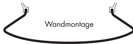
Wandmontage: Schutzprofil aufdrücken
