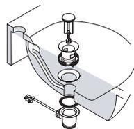
ポップアップ蓋を反時計回りに回すとロックナット調整ネジがはずれ、配管内に落ちることがあります。
