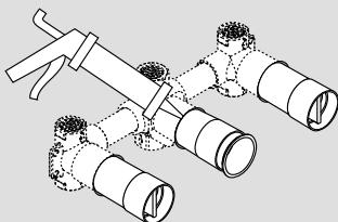
Der pudses op omkring den indbyggede og afprøvede grundkrop; ved installation foran væggen sættes paneler op.
