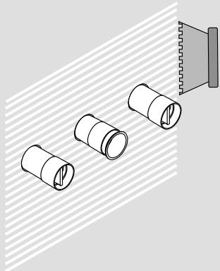
Påfør væggen vådrumsmembran eller en lignende klæbemasse.
