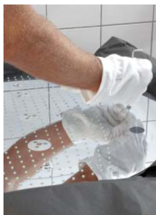
13. Skrueene løsnes og den seglformede afdækning fjernes.
