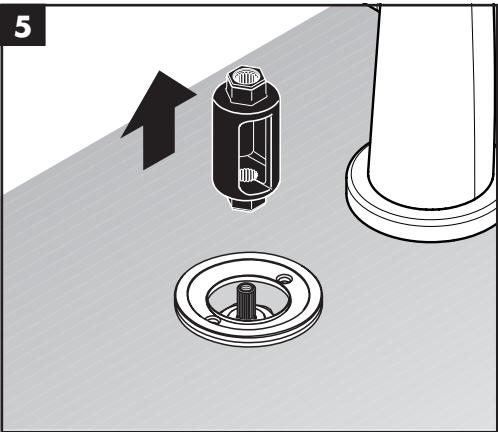
**Set the high temperature limit stop / Réglez la butée limite d'eau chaude / Fije el tope de límite de alta temperatura**
