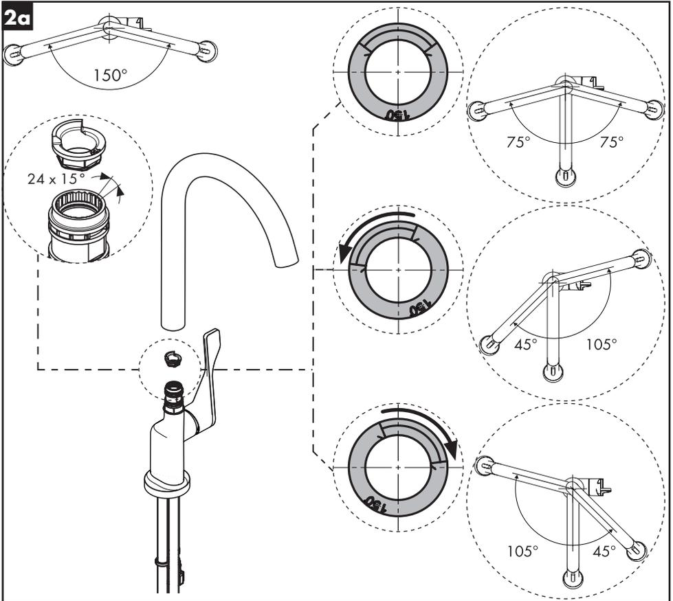
**Optional: Adjust the spout rotation / En Option : Ajustez la Rotation du Bec / Opcional: Ajuste la Rotación del Surtidor**
